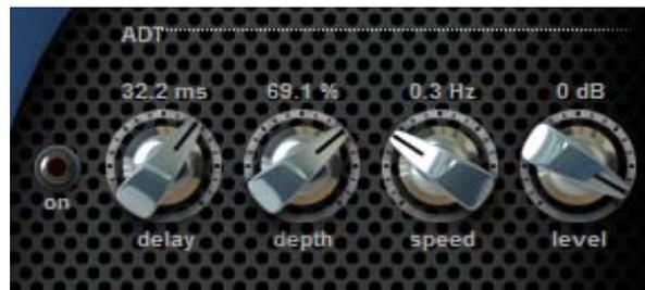
Der **Delay**-Drehknopf spezifiziert die Verzögerung zwischen dem Originalsignal und dem zweiten Signal in Millisekunden. Eine Verzögerung von ca. 40 ms ist ein typischer Wert, um schon einen Effekt zu erzeugen.
